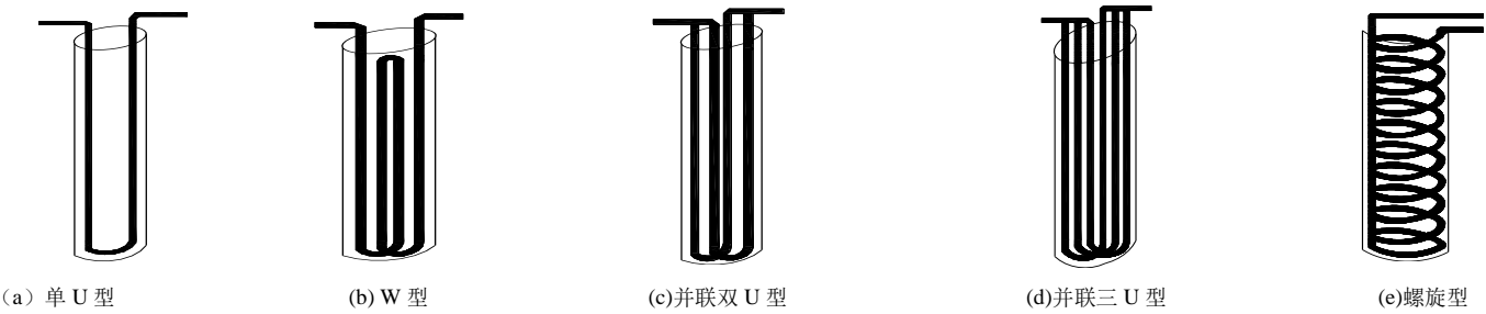
图 1 桩基埋管型式示意图
